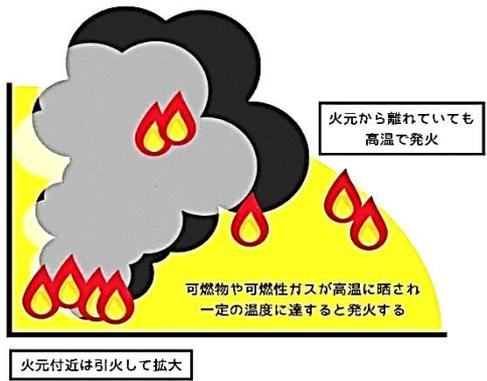
室内の局所的な火災が、数秒～数十秒のごく短時間に、部屋全体に拡大する現象の総称である。局所的な火災によって熱せられた天井や煙層からの放射熱によって、局所火源そのもの、あるいはその他の可燃物が外部加熱を受け、それによって急速な延焼拡大が引き起こされ全面火災にいたる。
