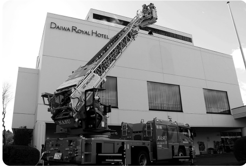
はしごの長さは35mあり、はしご先端を屈折させ高層建物の屋上やフェンス等を避けて接近できます
