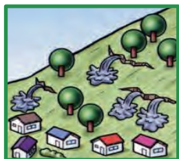
◆斜面から水がふき出る
