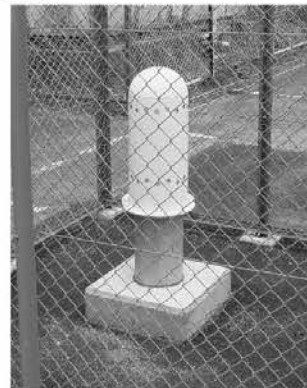
役場駐車場内に設置されたモニタリングポスト
